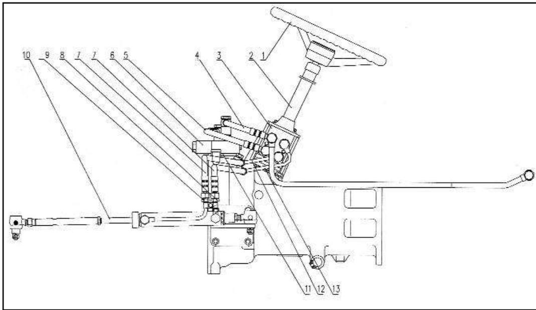
Ilustración 5: Esquema de dirección hidráulica
